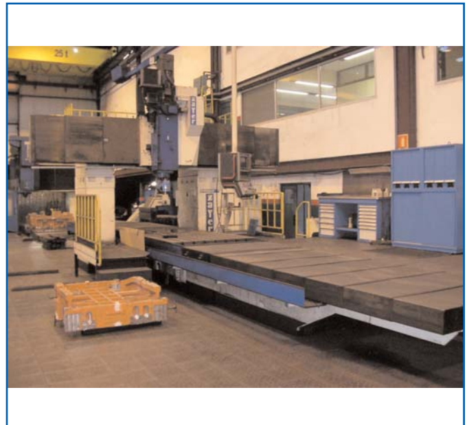
Nº 7881 FRESADORA PUENTE ZAYER 6000 BFP CNC
