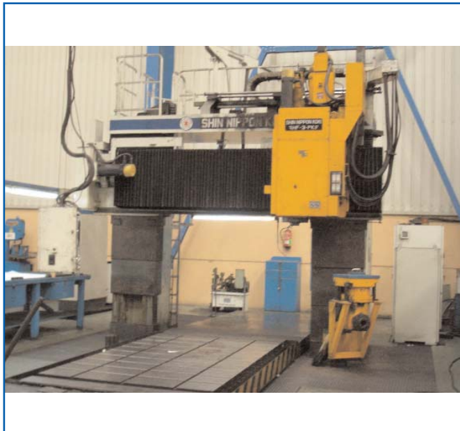
Nº 7203 FRESADORA PUENTE CNC SNK SHIN NIPPON KOKI tipo HP 3 PK
