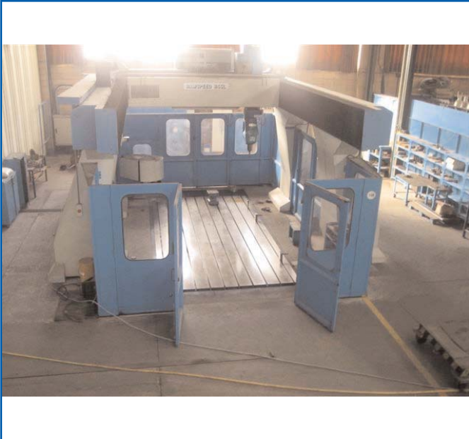
Nº 7910 FRESADORA PUENTE CNC 5 EJES C/CBZAL ORB.RAMBAUDI mod. RAMSPEED H tipo H45L
